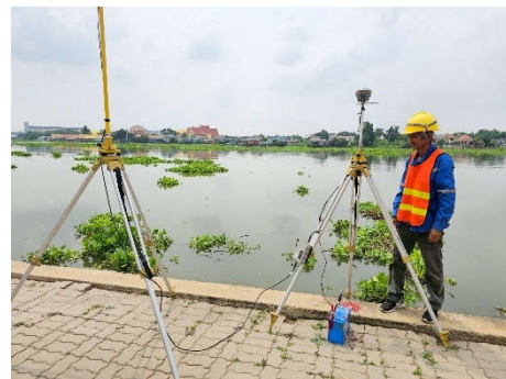
ภาพที่ 3.2.4-3 ตั้งสถานี GNSS-RTK Base Station
