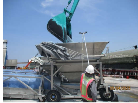
บริเวณรถแบคโฮตักสินค้าจากเรือสินค้า ใส่ Intake Hopper ของสายพานลำเลียง
