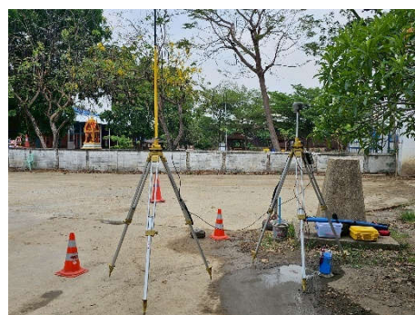
ภาพที่ 3.2.4-2 รังวัดค่าพิกัดหมุดควบคุมโครงการด้วยเครื่องรับดาวเทียม GNSS
