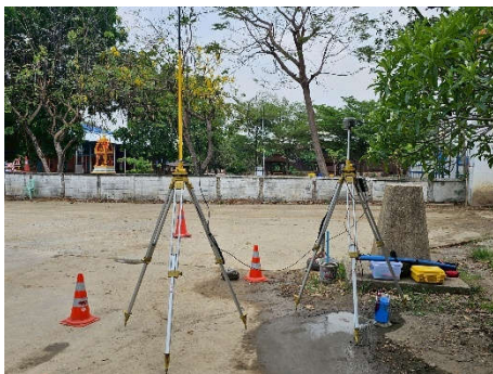
ภาพที่ 3.2.4-3 ตั้งสถานี GNSS-RTK Base Station
